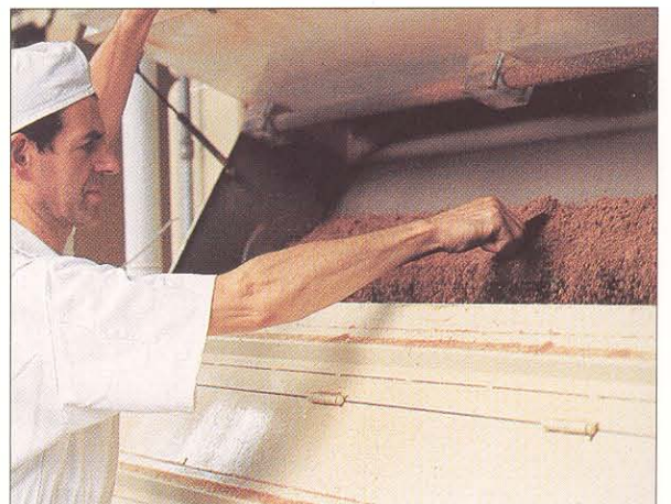
Sobre los cilindros de acero la pasta de chocolate se estira de abajo hacia arriba y forma una película finísima, que aparece como un revestimiento mate. Desprendida con una rasqueta, la pasta cae en forma de polvo sobre una cinta transportadora.
